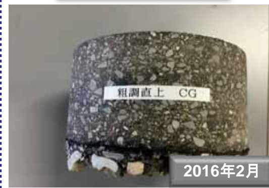
コア抜き試験
