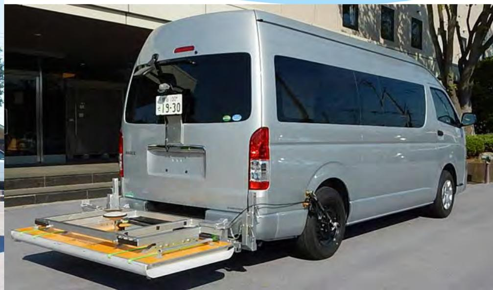
3D電磁波レーダ調査車両
