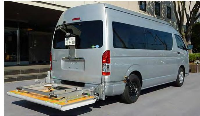
② 3D電磁波レーダにて耐水箇所を検出
