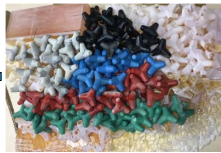
⑤ブロック模型による嵩上げ ※据付層ごとに色分け
