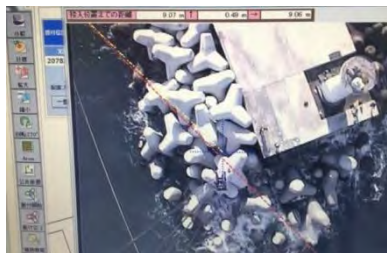
⑥写真画像から得られた位置座標を目標 にブロックを誘導して据付 (ICT施工)
