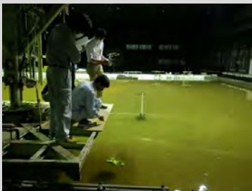
造波水路 長さ100m×幅2m×深さ2m
