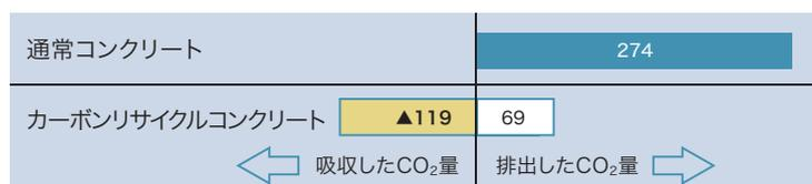
コンクリート製造時のCO<sub>2</sub>排出量の収支 単位(kg/m<sup>3</sup>)
