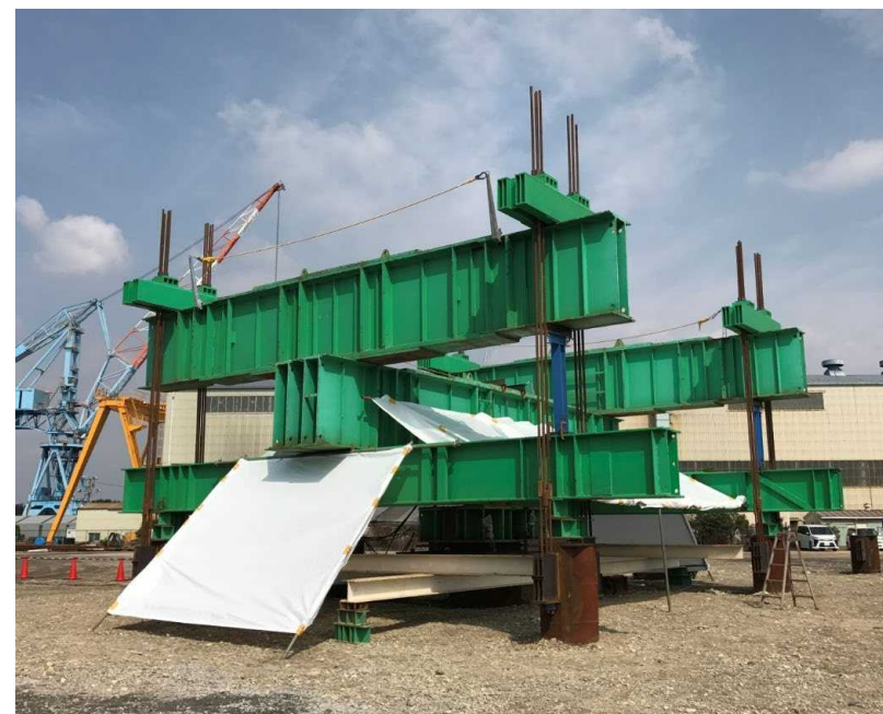
テーパー杭押し込み抵抗値 16,621(kN) : 推定値 ストレート杭押し込み抵抗値 11,725(kN)
