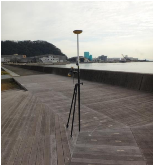
GNSS測量機器
