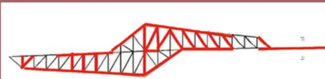
東京ゲートブリッジにおけるBHS鋼材使用箇所
