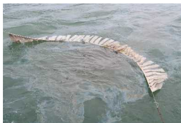
油吸着材(万国旗状)による流出油の回収
