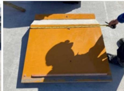
飛散した型枠材
