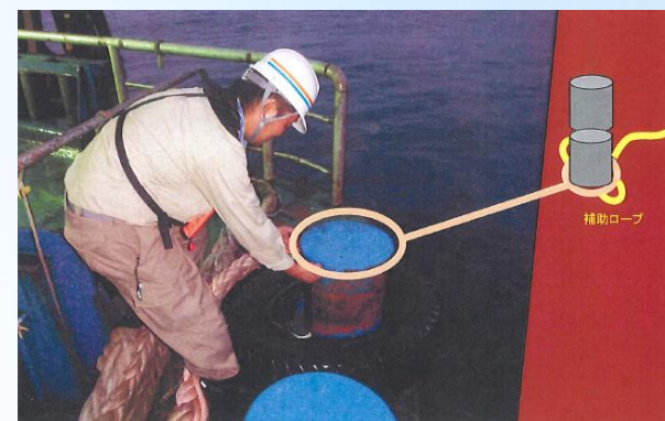
浚渫船のビットと舳ロープに手を挟む
