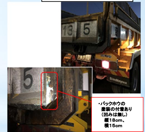
ダンプトラック損傷状況
