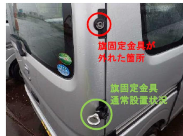
標識旗紛失車両金具外観
