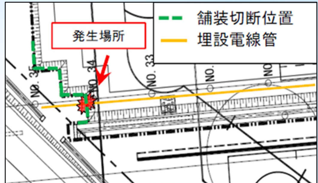
注視ポイント不備による事故の事例
