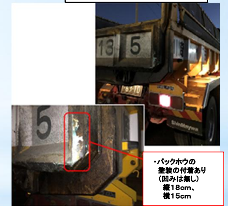
ダンプトラック損傷状況
