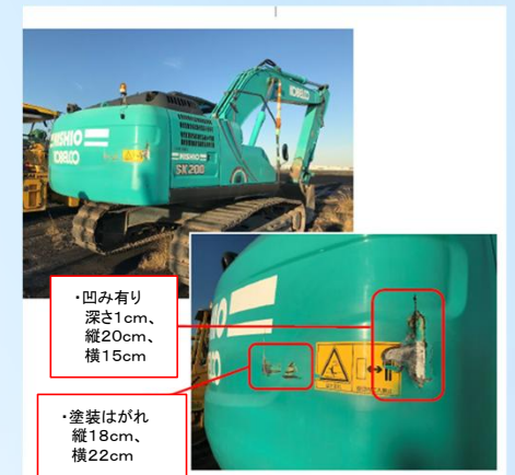
バックホウ損傷状況
