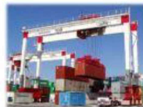
ハイブリッド型トランスファークレーン
