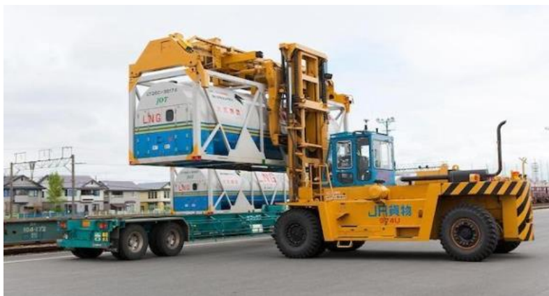
鉄道基地でのLNGタンクコンテナ積み込み作業(出典:JAPEX)
