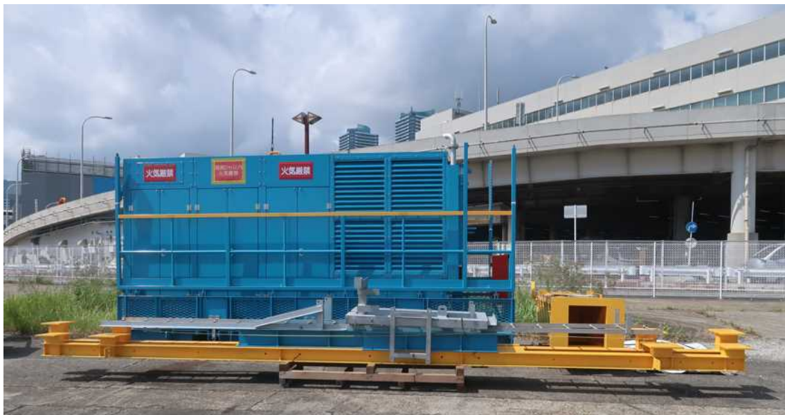
燃料電池電源ユニット 一式
