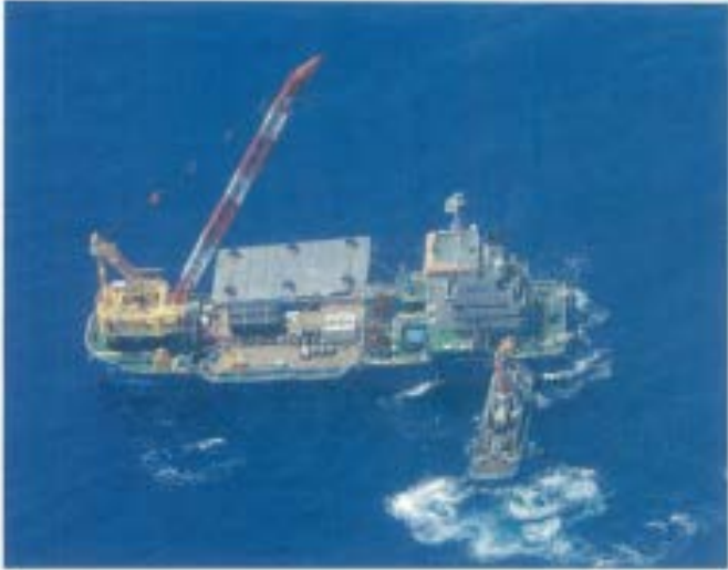
起重機船に転倒した中央棧橋を横付けしている状況
