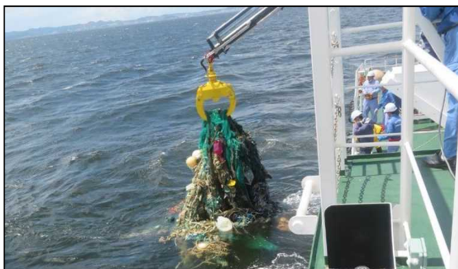
清掃兼油回収船「べいくりん」 による浮遊ゴミの回収作業
