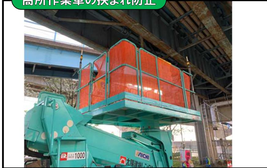
構造物との挟まれ事故防止する接触警告装置の採用
