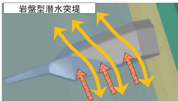
平常時の土砂の移動を妨げず、高波浪時に土砂の移動を制御することで、砂浜の回復を図ります。
