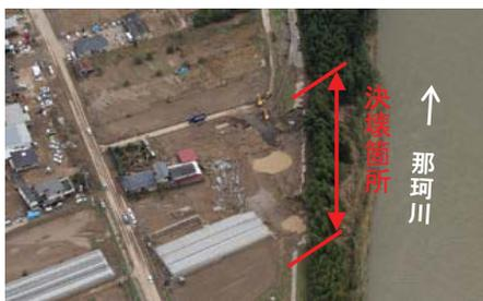
写真③堤防決壊状況(那珂川左岸40.0k)
