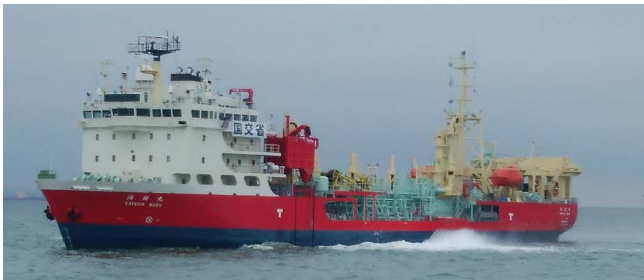
流出油の防除作業を行う浚渫兼油回収船「海翔丸」
