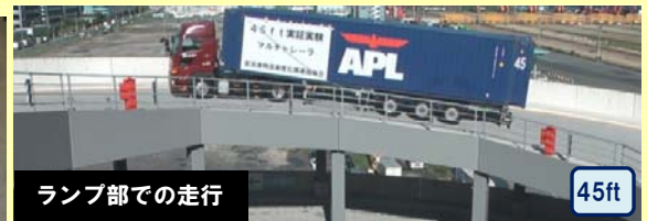
車両後端と路面との接触状況
