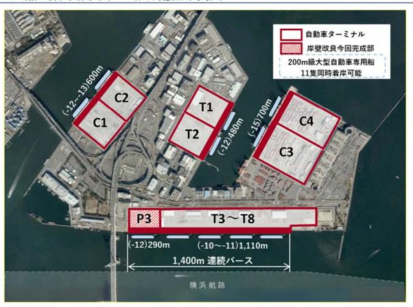
※これまでの P3, 4 岸壁 (-7.5m, 260m) は、P3 岸壁 (-12.0m, 290m) に名称を変更し運用します。
