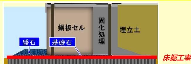
計画水深-24.5mとなるように、グラブ浚渫船で海底土砂を掘削しています。
