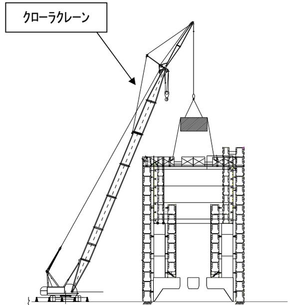
写真 ニューマチックケーソン基礎工 鉄筋組立
