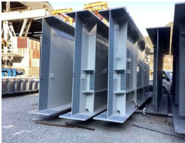
工場製作(5工区・日立) 令和4年12月 (主桁)
