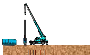
四方に仮設土留め板を圧入し、内側を掘削します。
