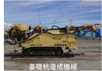
基礎杭造成プラント設置
