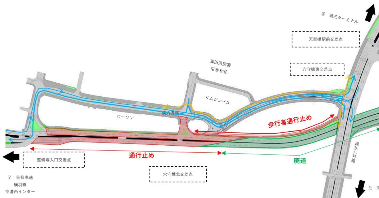
規制状況図②片側交互通行規制 21:00～6:00(施工実施日のみ)
