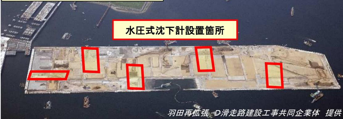
水圧式沈下計設置箇所
