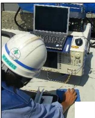
左の写真は、接続部の滑走路直下に設置されている、光ファイバセンサの計測を現場にて実施しているところです。正常に計測ができているかを確認するとともに、現時点の計測結果から、施工時の挙動を把握することができます。
