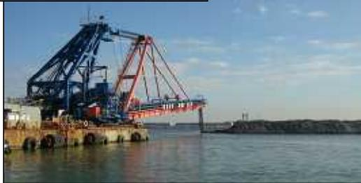
中仕切堤2は主にガット船で岩ズリを投入して造りますが、リクレーマ船と土運船で造っている箇所もあります。作業スピードはリクレーマ船の方が速いですが、現場海域では様々な作業が輻輳しているため、本現場には1隻しかいません。
