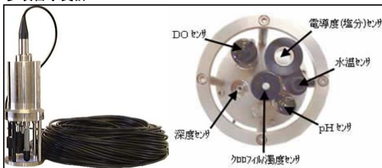
(測定項目:水温・塩分・濁度・DO・クロロフィル・pH)
