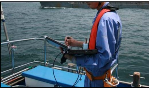
多項目水質計を垂下させているその横で、出力されたデータをチェックします。
