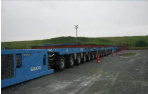
上部ジャケットの搬入に使用するドーリー(特注品)
