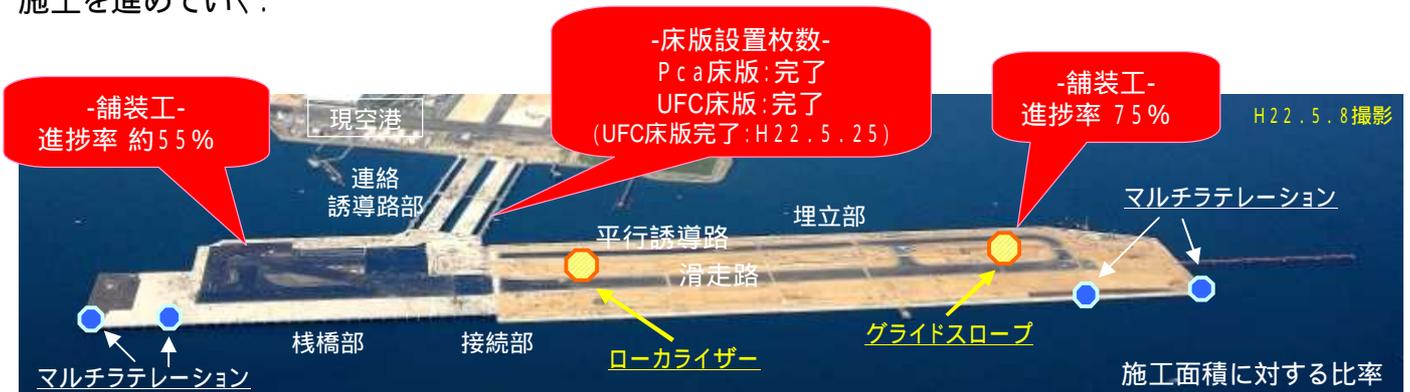
ローライザー:最適な進入コースの情報を提供する装置,グライドスロープ:最適な降下角・距離情報を提供する装置
