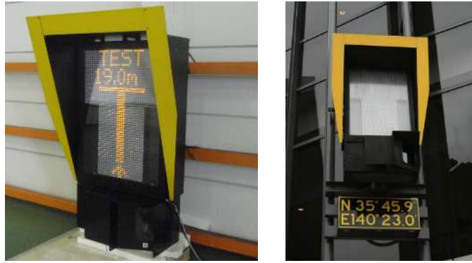
写真-3 VDGSの外観写真（左側：デモ機動作テスト中、右側：新東京国際空港より）
