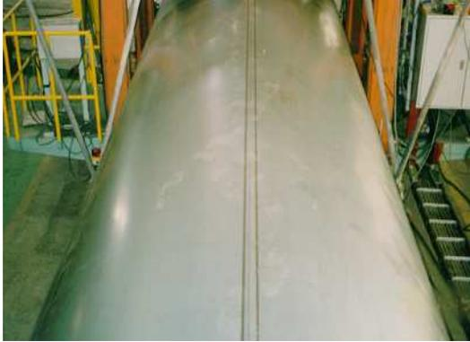
図-9 インダイレクト抵抗シーム溶接部外観
