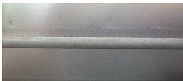
図-20 電解研磨後の表面状況
