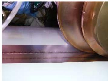
シーム溶接電極(溶接中)
