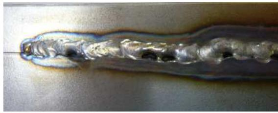
図-5 溶損による穴あきビード (1.0mt SUS304)
