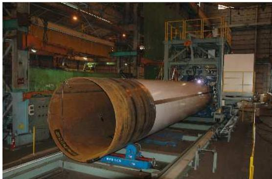
図-15 ライニング溶接装置
