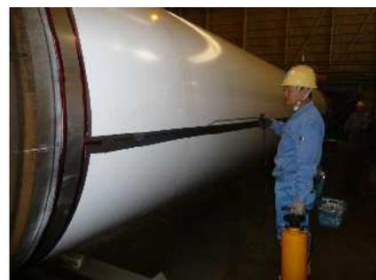
図-21 発泡漏れ検査の状況
