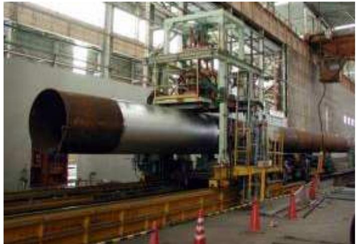
図-12 インダイレクト抵抗シーム溶接装置
