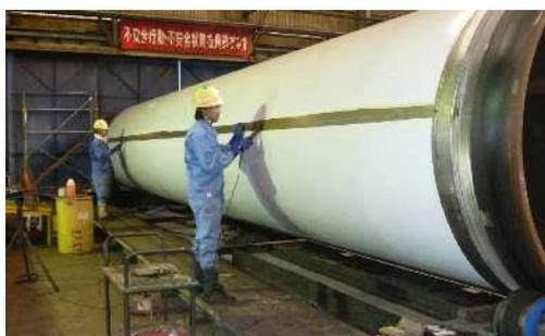
図-19 電解研磨による高温酸化部除去の状況
