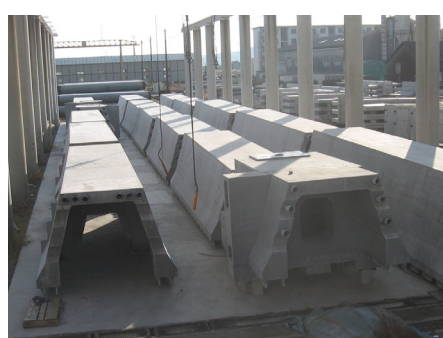
図3.12 完成したUFCセグメント(反転前)
