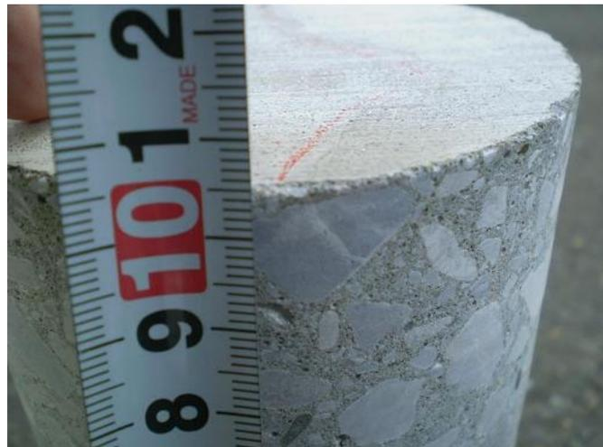
写真-4 4ヶ月目に生じたひび割れ箇所
