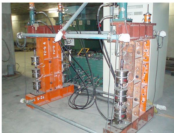
写真-1 引張クリープ供試体
