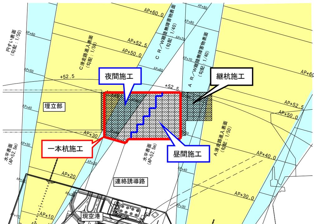
図-2.4 基礎杭打設工の施工エリア区分
