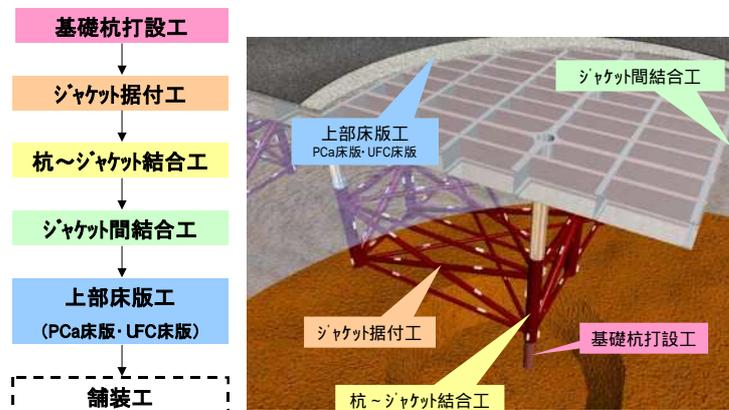
図-2.2 栈橋部構造
