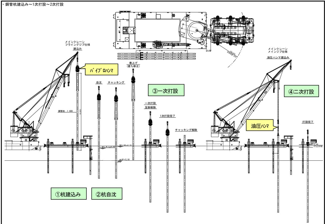
図-4.2 杭打設ステップ図
