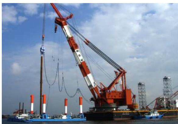
写真-4.1 1,600 t吊級杭打台船
