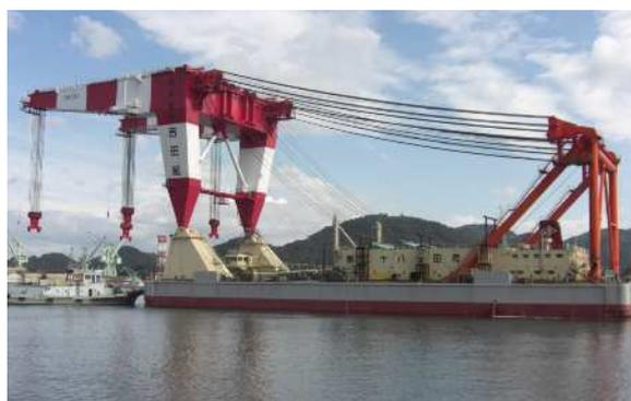
写真-6.2 起重機船（改造後）
