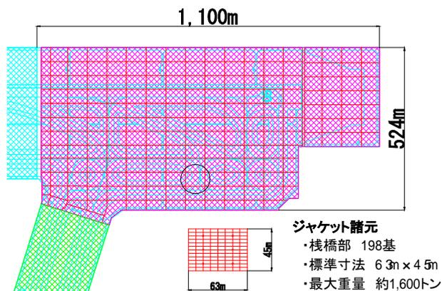
図-2.3 栈橋部平面図
