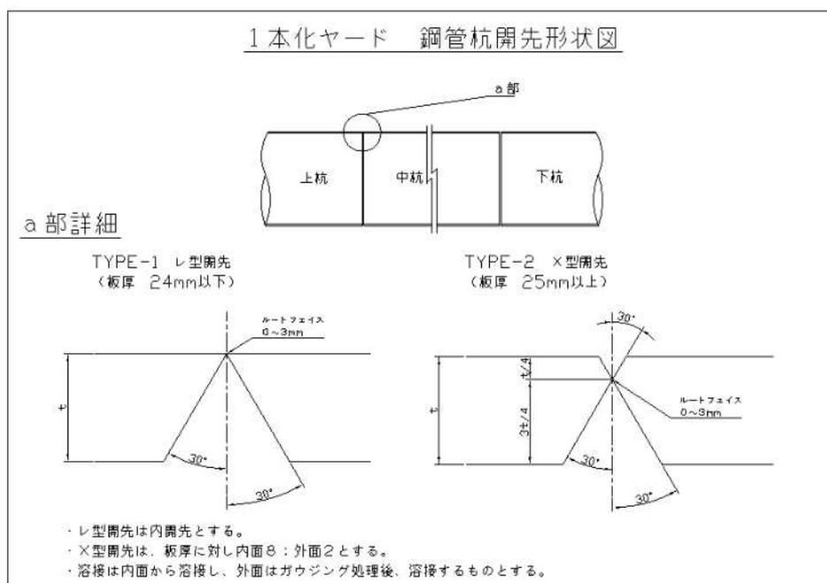
図-3.2 鋼管杭開先形状図
