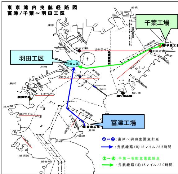
図-5.1 ジャケット海上運搬経路
