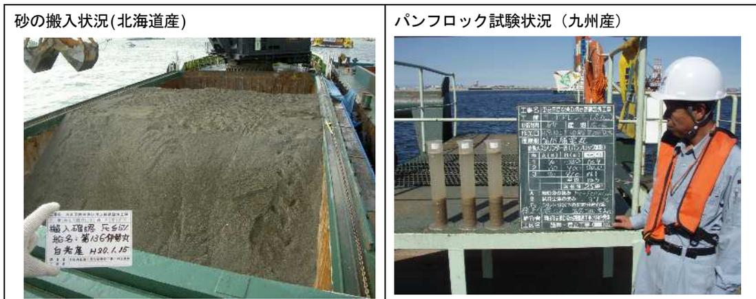
写真 3-3-1 砂の搬入状況およびパンブロック試験状況
