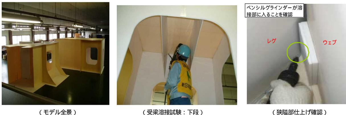
図 8 実寸大模型による支承受梁部の製作性検証
