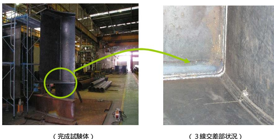
図 9 実寸大模型によるレグ頭部の溶接施工性検証
