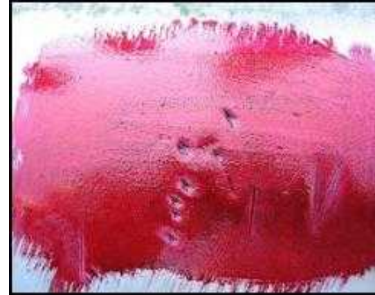
浸透探傷試験状況
