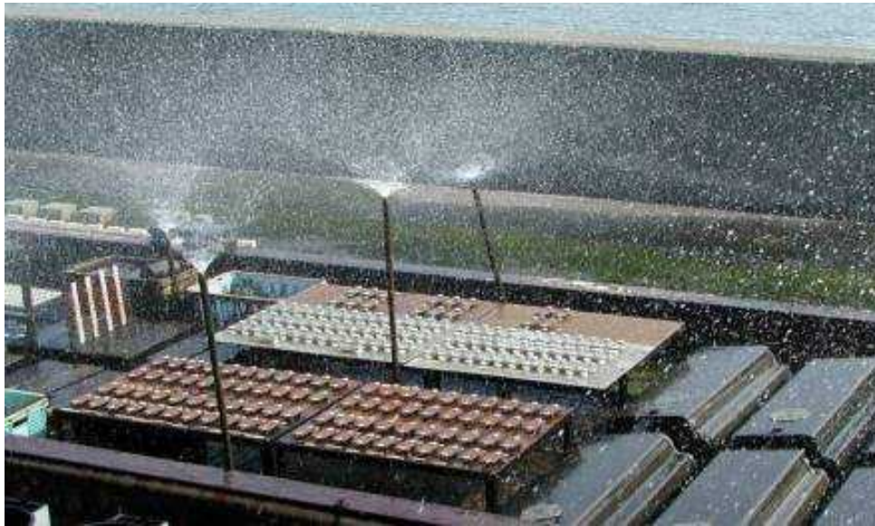
ステンレス鋼の耐食性評価試験 (港湾空港技術研究所)
