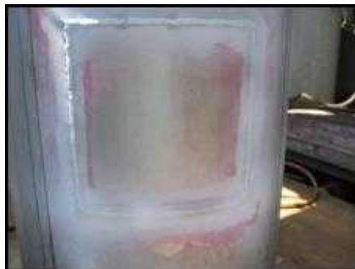
浸透探傷試験状況
