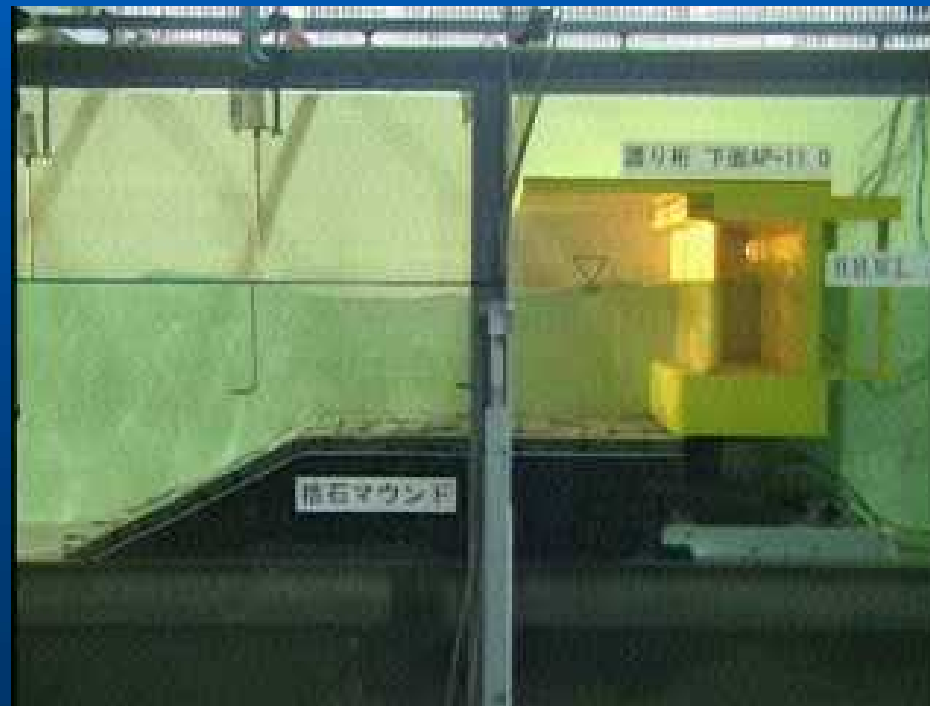
消波護岸の実験状況 (円柱スリット、開口率33%)
