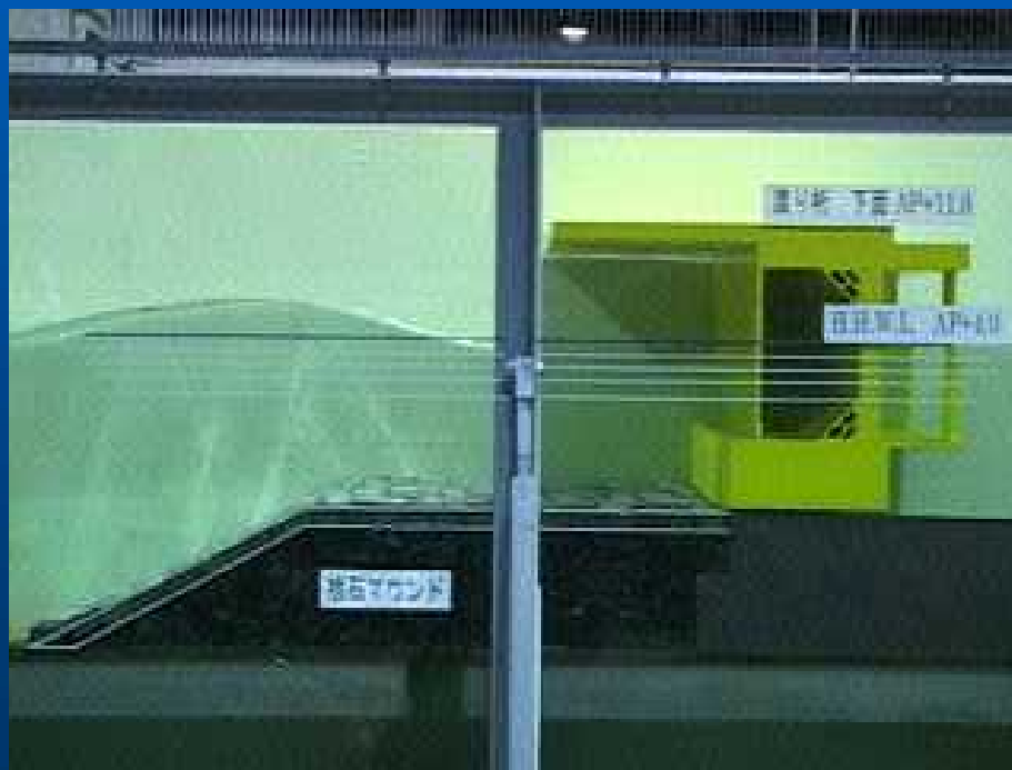
直立護岸の実験状況
