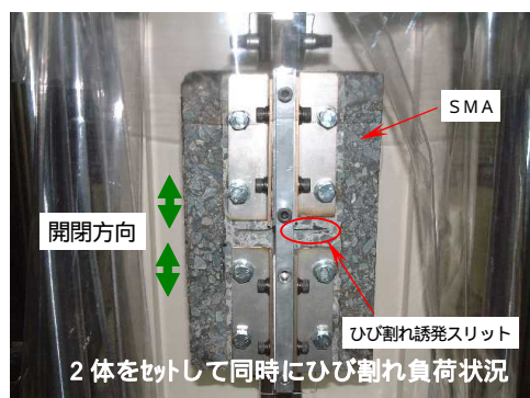
図-13 防水層性能確認試験(ひび割れ開閉試験)試験体
