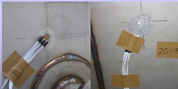
ひずみゲージの貼付状況 (右はコーティング後)
