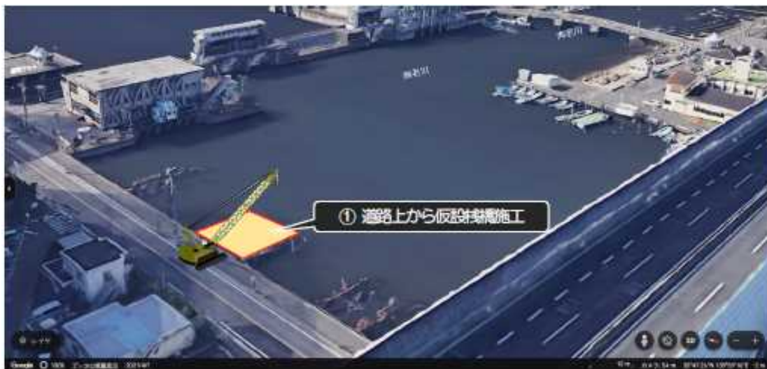
① 道路上から仮設棧橋を施工
