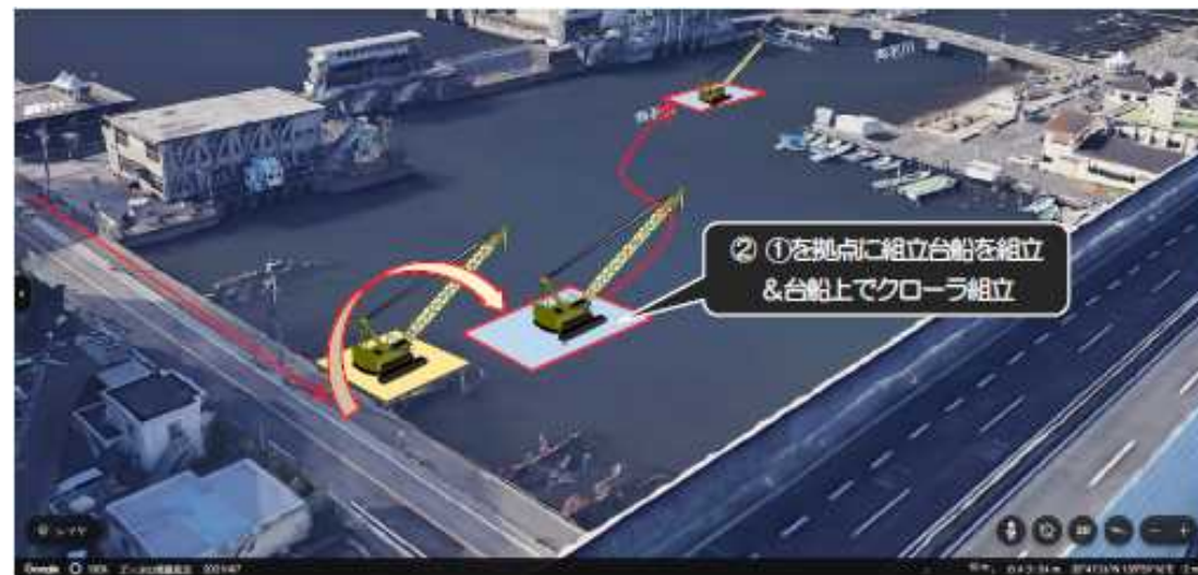
② 組立台船の組立、台船上でクローラ組立
