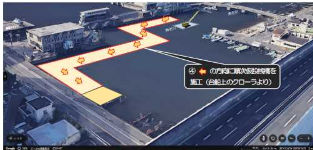
④ 台船上のクローラにて仮設棧橋を施工
