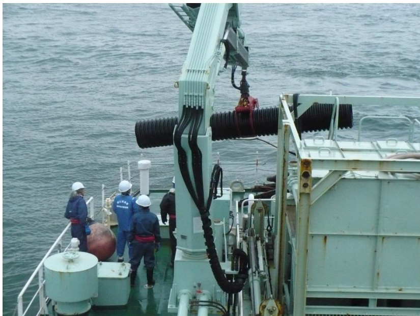
プラスチック管をクレーンにて回収
