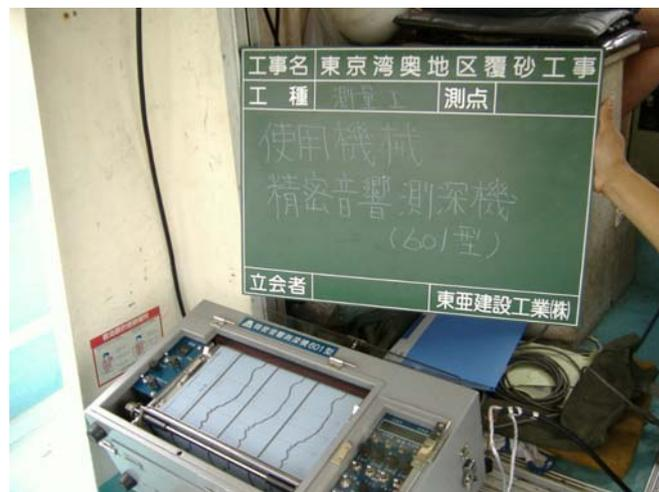
図 3-17 精密音響測探機
