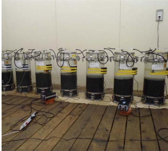
図 4- 22 溶出試験装置
