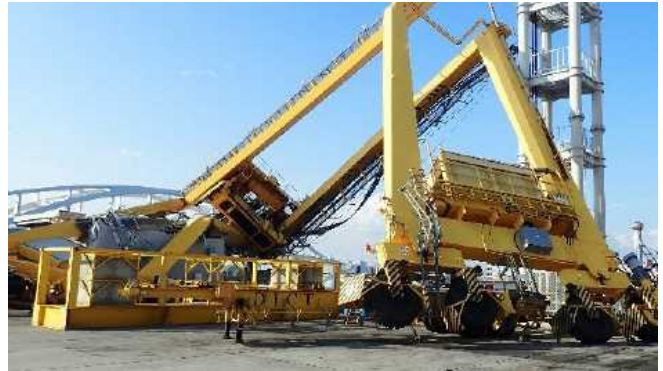
空コン及び SOLAS フェンスの倒壊
